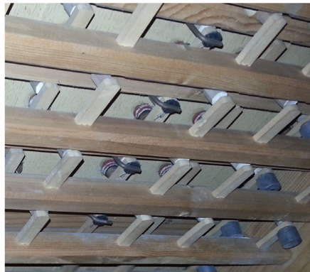
Mechanische Holzleisten zur Betätigung der Kegelladen.
